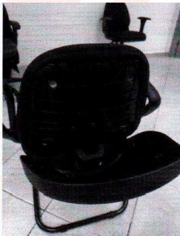
Pode ser observado que o chassi se trata da contracapa de encosto, material fabricado em polipropileno, acontece que tal componente é fixado no encosto por fricção, ou seja não utiliza nenhum tipo de parafuso ou presilhas.
