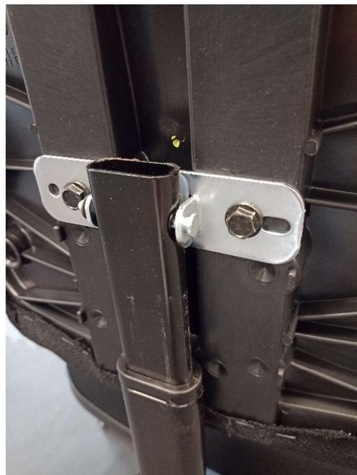
*Amostra: suporte do encosto fabricado com tudo de secção oval, com espessura da parede do tubo entre 1 e 2mm.*
