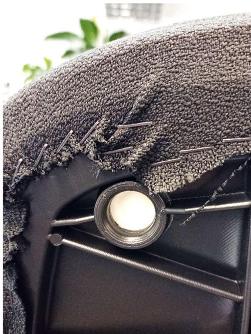
*Amostra: fixação dos revestimentos do assento e do encosto com grampos de metal fixados diretamente na estrutura).*
