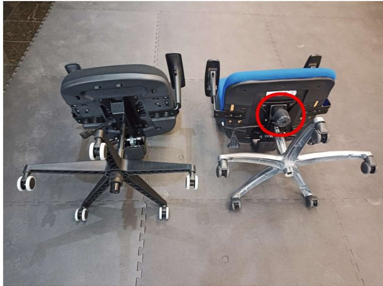
*Comparativo de uma cadeira com mecanismo de regulagem de tensão do suporte de encosto (lado direito da imagem) e da cadeira apresentada como amostra sem ajuste de tensão do suporte de encosto (lado esquerdo da imagem).*
